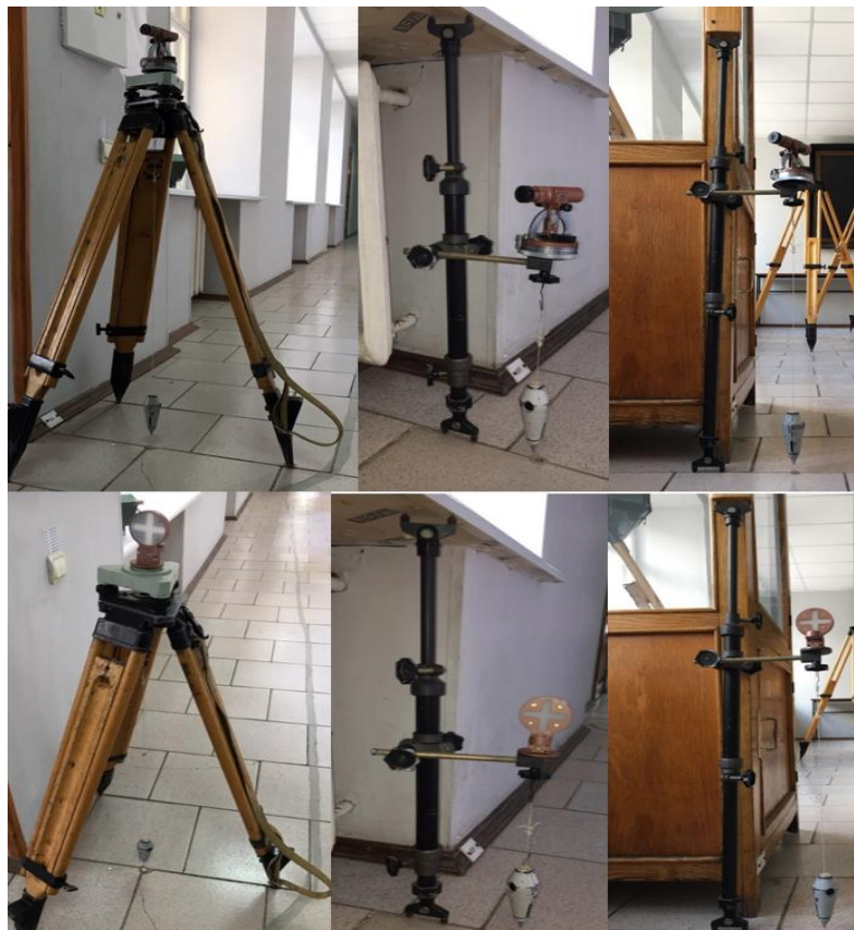
Рисунок 2 – Установка угломера У-60 и визирной марке на штативе и на установочной колонке
