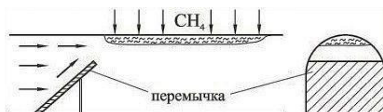
Рис. 5. Схема монтажа перемычки в нижней части выработки
