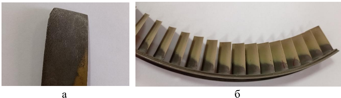
Рисунок 1. а – износ рабочей лопатки компрессора, б – неравномерный абразивно-эрозионный износ направляющего аппарата лопаток компрессора
