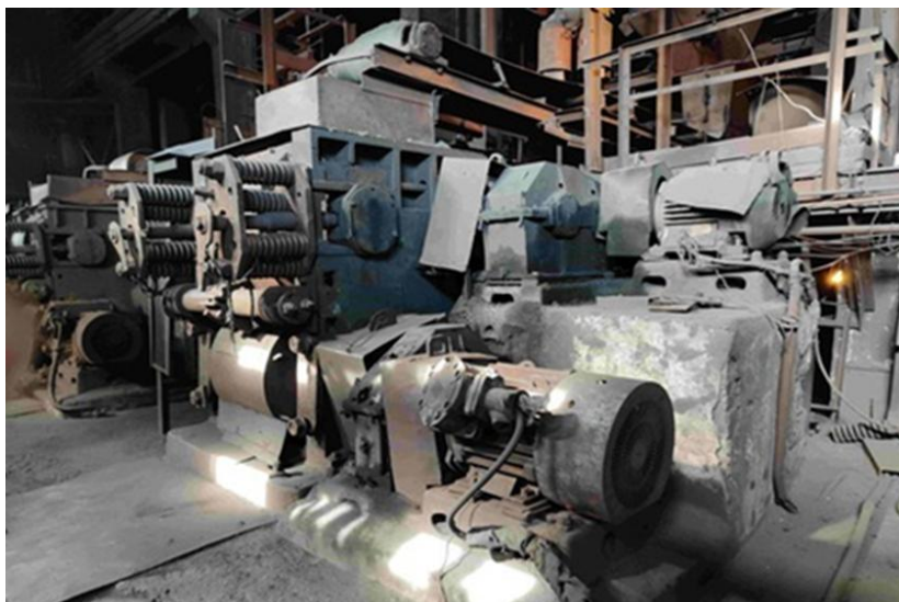
Рисунок 1 – Четырехвалковая дробилка ДЧГ 900×700 с МПЭЭДТ в промышленных условиях
