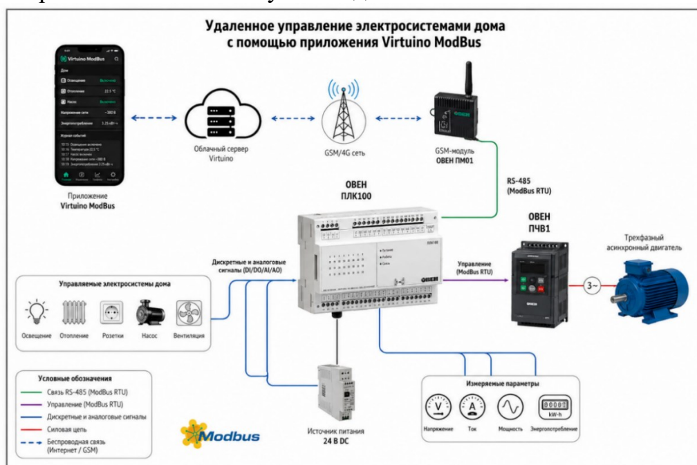
Рисунок 1 – Структурная схема системы дистанционного управления электросистемами дома
