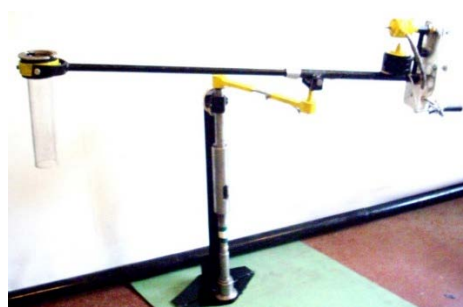
Рисунок 2 – Натурная модель манипулятора для удержания защитной огнеупорной трубы
