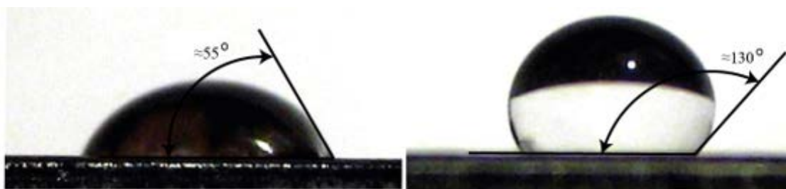
Рисунок 3. Макрофотография капли на поверхности РК насоса в исходном состоянии и после нанесения покрытия на основе ПАВ
