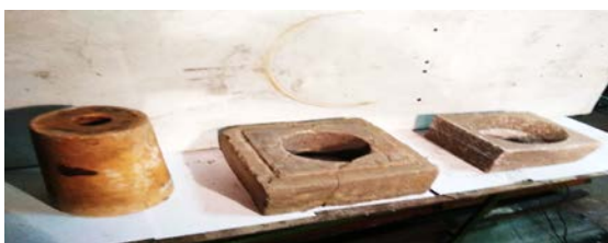
Рисунок 2 – Схема оформления гнездового блока ковша ( а ) и подготовленный к эксперименту комплект огнеупорных изделий ( б ): 1 – разливочный стакан; 2 – составной гнездовой кирпич.
