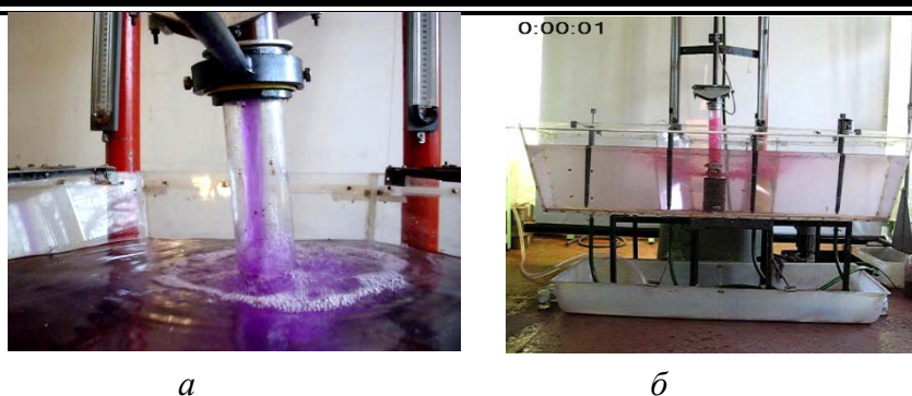
Рисунок 4 – Моделирование разливки по существующей технологической схеме (а) и с разрежением в полости защитной трубы (б)
