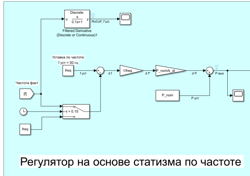
Рисунок 2 – Разработанная САУ преобразователя со статизмом по частоте, представленная в Matlab Simulink
