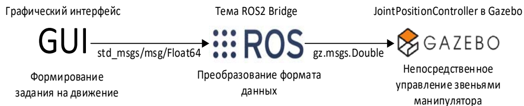
Рисунок 2 – Схема передачи данных из интерфейса в Gazebo
