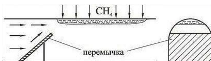
Рис. 5. Схема монтажа перемычки в нижней части выработки
