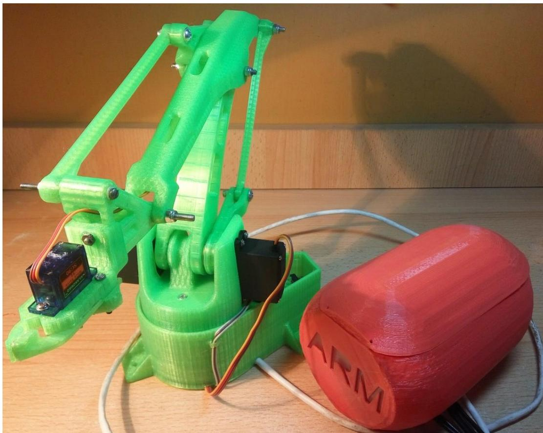
**Цель работы:** создание устройства, наглядно демонстрирующего работы бионического протеза на базе ЭМГ датчиков (в модели в качестве управляющего устройства используется манипулятор).
