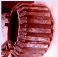
Входное окно броневой выемки дробилки типа БЗД-100 (Сталь 30Г)
