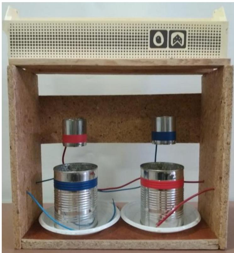
Назначением «Капельницы» является преобразование потенциальной энергии падающих капель в электрическую. Электрическое напряжение, создаваемое таким устройством, может достигать нескольких киловольт.
