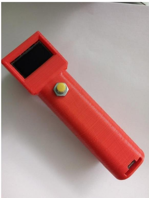
Устройство позволяет измерять температуру объектов на расстоянии до 20 см.
