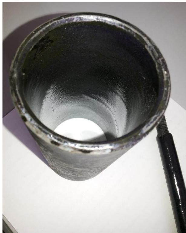
**Стеклоэмалирование** – процесс нанесения на поверхность металлических изделий тонкого слоя (0,2 мм) специального стекла (эмали).
