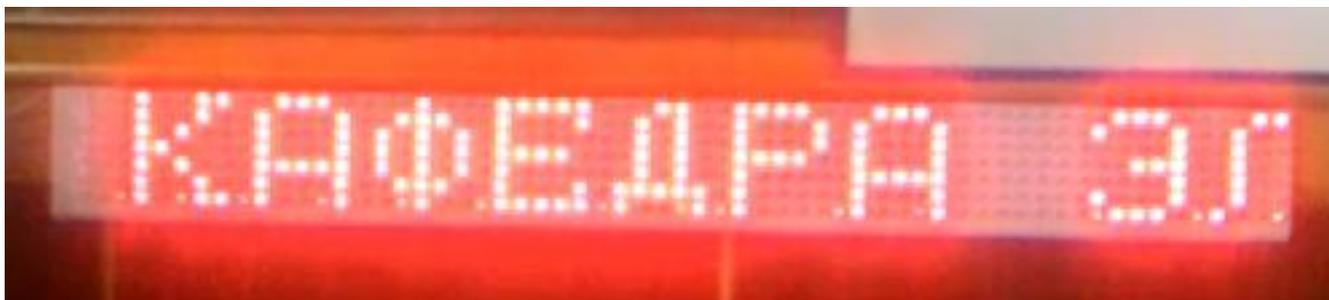
**Цель разработки:** демонстрация возможностей использования современных светодиодных лент с попиксельной адресацией и построения на их основе информационных панелей типа «Бегущая строка».
