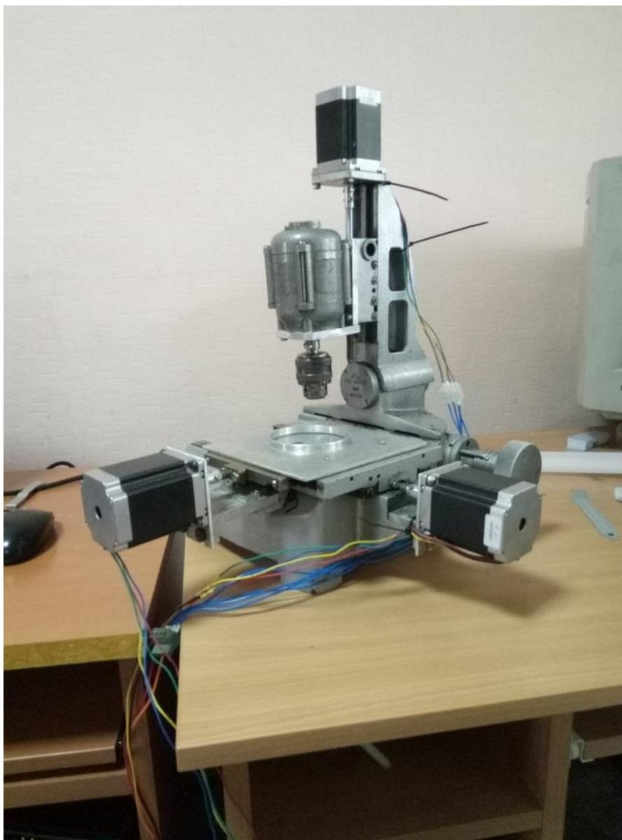
На кафедре МСМО с участием студентов был спроектирован и изготовлен настольный сверлильно-фрезерный станок с числовым программным управлением.
