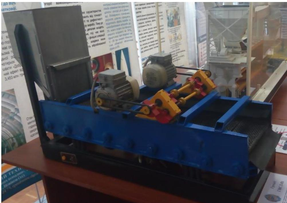
Грохот инерционный самобалансный ГИСЛ-81 предназначен для грохочения сыпучих материалов с обычной массой насыпного груза до 1,4 т/м<sup>3</sup> при угле наклона просеивающей поверхности от 0 до 15° на операциях обезвоживания, обесшламливания, мокрого и сухого грохочения каменных углей, антрацитов и горючих сланцев крупностью кусков питания не более 300×300×600 мм, а также отмыва суспензии от продуктов их обогащения.
