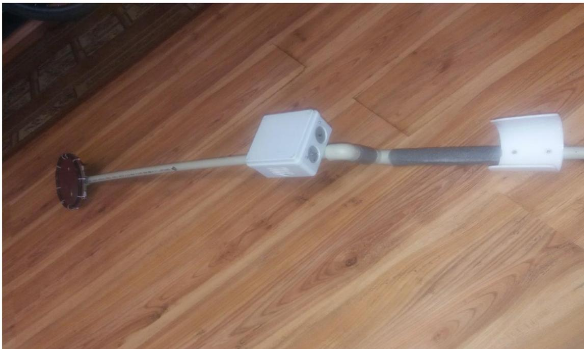
Я улучшил свой металлоискатель, теперь он мощнее предыдущей версии и ещё добавлен дисплей, на который выводится информация о дальности металла. В этой версии металлоискателя используется Arduino Pro Mini, которая компактнее, чем Arduino UNO, которая использовалась в предыдущей версии.
