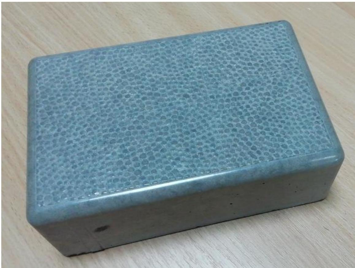
Плитка тротуарная выпускается на кафедре технологий строительных конструкций, изделий и материалов ГОУ ВПО «ДонНАСА». Ее геометрические размеры 180×120×60мм. Средняя плотность 230 кг/м<sup>3</sup>, масса 2,96 кг, предел прочности при сжатии 30 Мпа. На 1м<sup>2</sup> площади – 46 шт.
