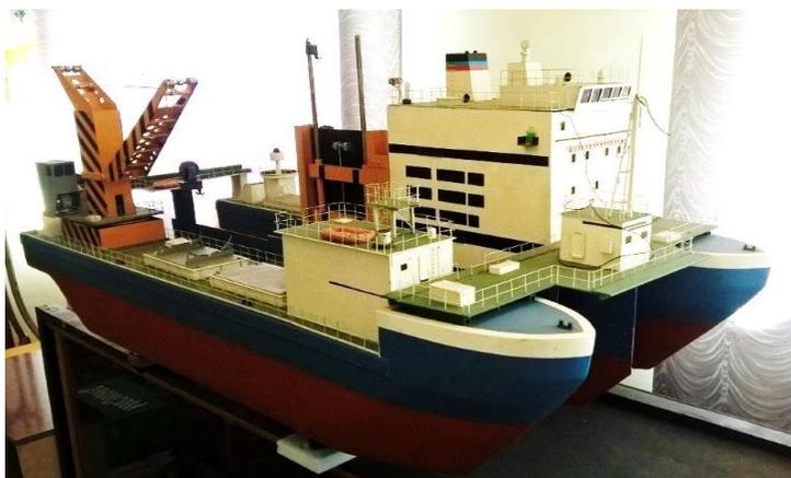
**Цель работы:** создание судна-спасателя для глубоководных исследований морской акватории, а также транспортировки аварийных объектов размером до 50-ти метров и доставки их в порт для ремонта. Также может выполнять снабженческие операции (доставку грузов и топлива).
