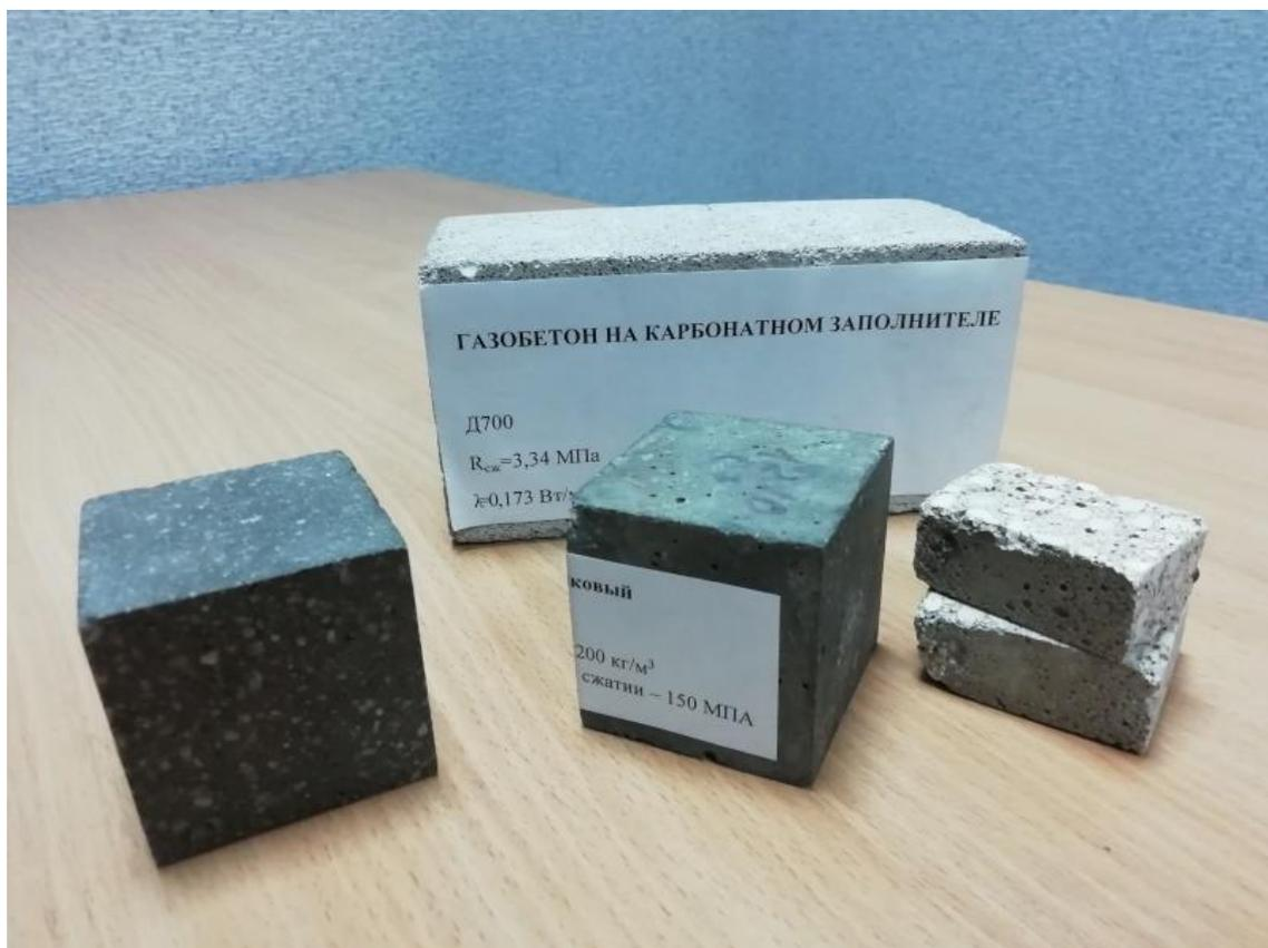
В лаборатории ДонНАСА разработан и испытан модифицированный неоклавный газобетон на карбонатном сырье марки по средней плотности D 500. При изготовлении газобетона используются отходы промышленности Донбасса.
