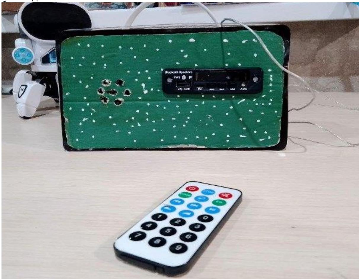
**Цель:** использование переносного многофункционального прибора, позволяющего: прослушивать радиостанции диапазона FM, подключения мобильного телефона по каналу Bluetooth, подключение любого источника сигнала через линейный вход AUX.
