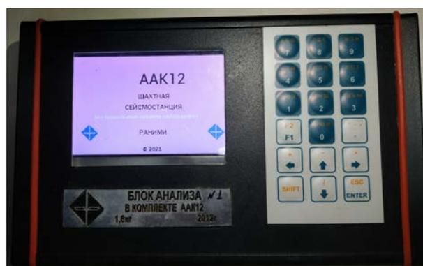
ААК12 предназначен для выполнения работ методами шахтной сейсморазведки с регистрацией и записью сигналов от сейсмоприемников (геофонов) в подземных горных выработках шахт (рудников) всех категорий, в том числе и сверхкатегорийных, опасных по газу и/или угольной пыли и может использоваться для реализации метода сейсмической локации из одиночной выработки с возможностью анализа полученной информации в шахтных условиях.
