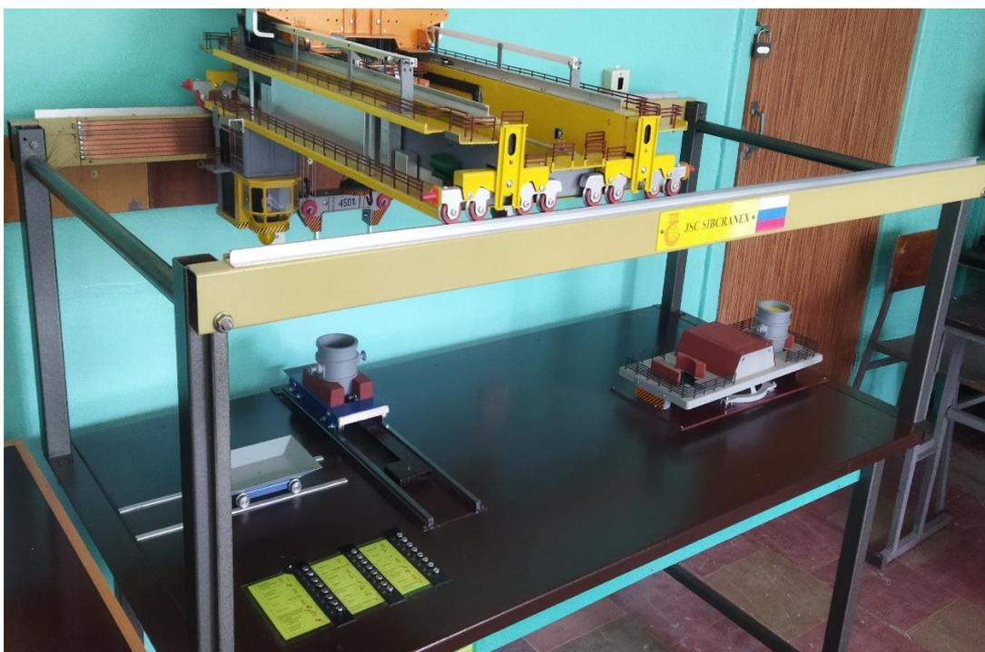
**Цель разработки:** создание действующей модели литейного мостового крана грузоподъемностью 450 тонн позволяет студентам изучить конструкцию и принцип работы крана.
