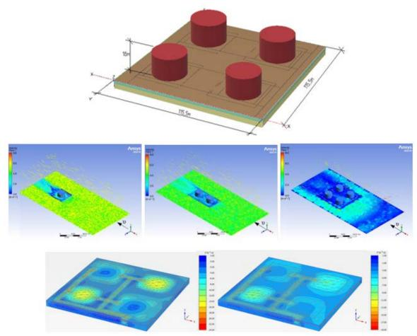
Разработана модель определения снегообразования (с последующим определением снеговой нагрузки) при различной компоновке резервуарного парка, скоростью ветра и углом атаки.
