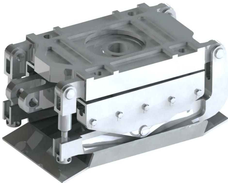
При такой кинематической схеме удастся поддерживать плотное прилегание огнеупорных плит даже в случае, если их толщина по длине разнится на 3 мм. Кроме того, материалом для всех корпусных деталей затвора служит конструкционная сталь 40, поэтому его стоимость значительно ниже в сравнении с используемыми аналогами.
