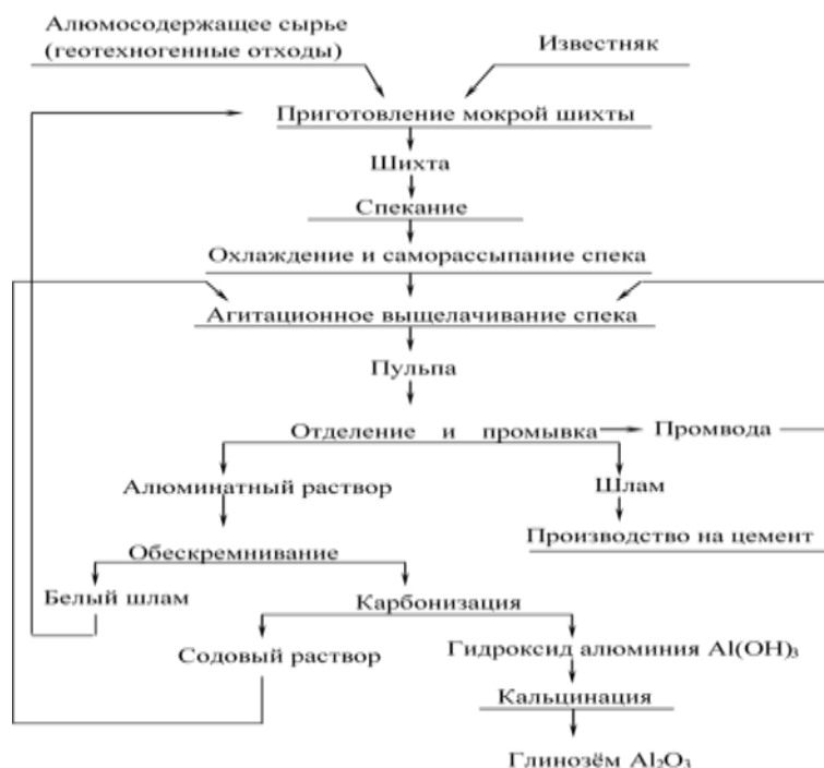
Рисунок 1. Технологическая схема производства глинозёма методом бесщелочного сырья с известняком
