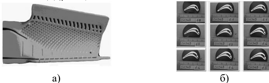
Рис.2 Фотографии: а) литейная форма внутренней; б) поперечные сечения лопатки ГТД
