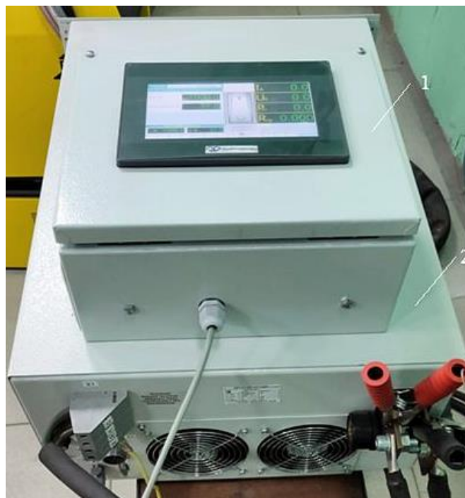
Рис. 1 - Инверторный источник питания ИОН 48-900: 1 – дистанционный пульт; 2 – силовой блок
