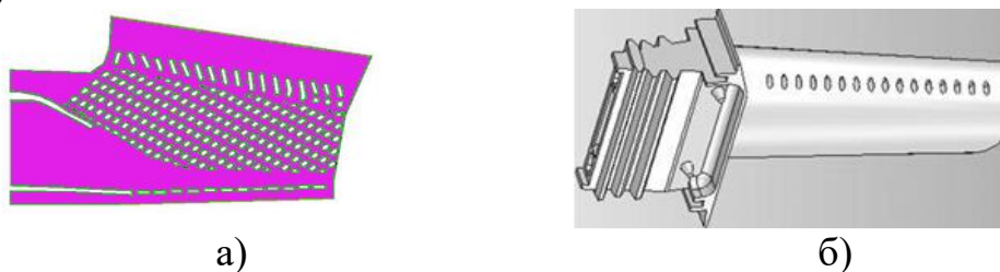
а) б) Рис.3. Результаты моделирования лопатки ГТД а) - 2D модель; б) - 3D модель
