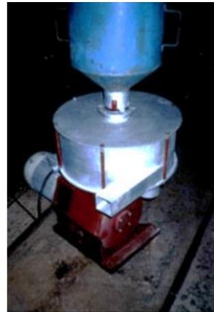
1 – корпус; 2 – отбойные плиты; 3 – течка; 4 – рама; 5 – распределительный конус; 6 – лопастной ротор; 7 – загрузочная горловина Рисунок 1 – Конструктивная схема и физическая модель разгонно-ударной дробилки
