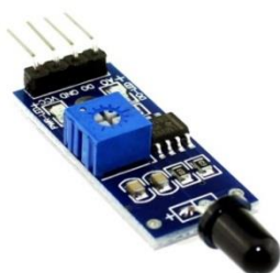
Рисунок 7 – Датчик огня и пламени
