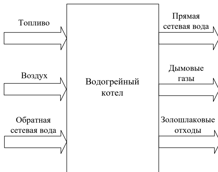
Рисунок 2 – Схема материальных потоков котла ДКВР-10/13, работающего в водогрейном режиме на угольном топливе
