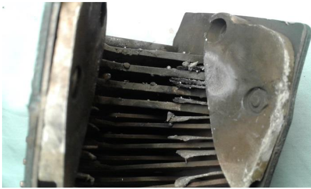
Рисунок 2 – Дугогасительная камера автоматического выключателя А3792 со следами электродугового воздействия при коммутации высоких токов: а - керамическая накладка в нижней части камеры со следами теплового воздействия электрической дуги; б - медные наплавления на дугогасительной
