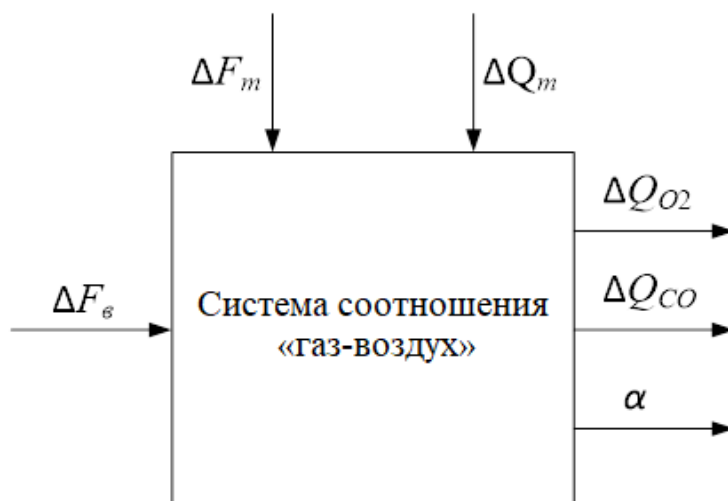
Рисунок 2 – Система соотношения «газ воздух» как объект управления
