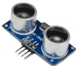
Рисунок 5 – Ультразвуковой датчик расстояния HC-SR04
