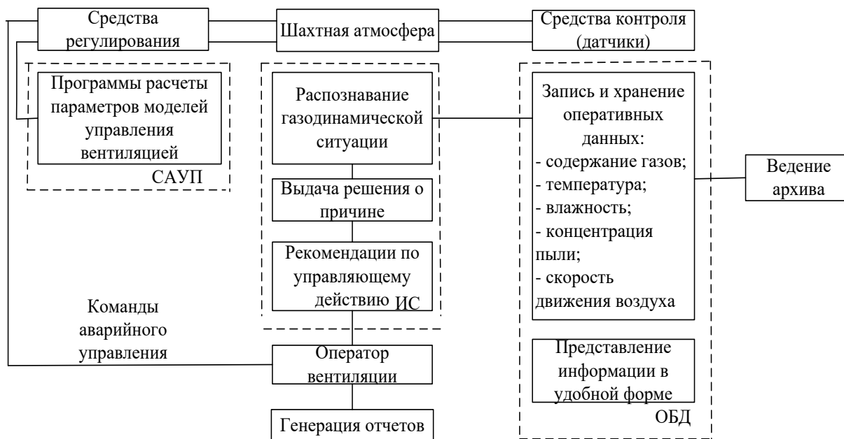
Рисунок 2 – Схема взаимодействия диспетчера с компонентами АСУТП
