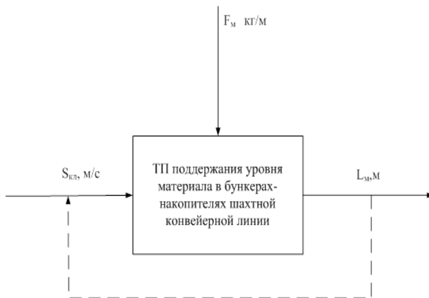
Рисунок 3 - Схема анализа процесса поддержания уровня материала в бункерах-накопителях шахтной конвейерной линии: а) схема материальных потоков и их информационных переменных; б) структурная схема процесса САУ
