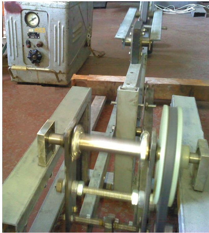
Рисунок 2 – Физическая модель механизма качания кристаллизатора радиальной МНЛЗ (вид с боку)
