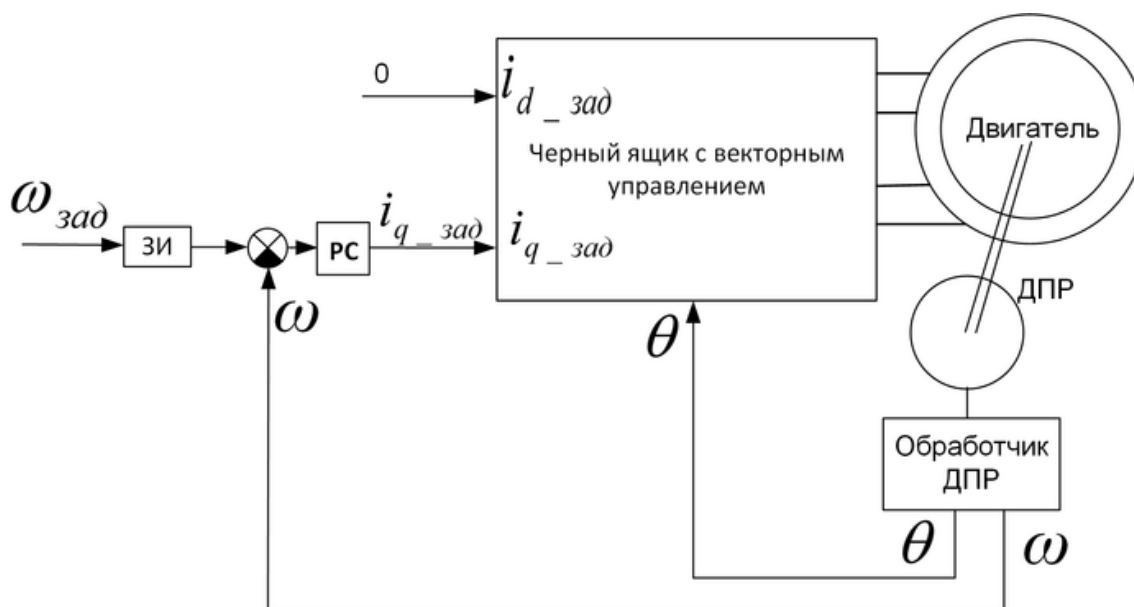
Рисунок 3 – Функциональная схема системы автоматического управления скоростью вращения асинхронного двигателя
