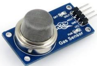
Рисунок 6 – Датчик угарного газа MQ-7 Gas Sensor
