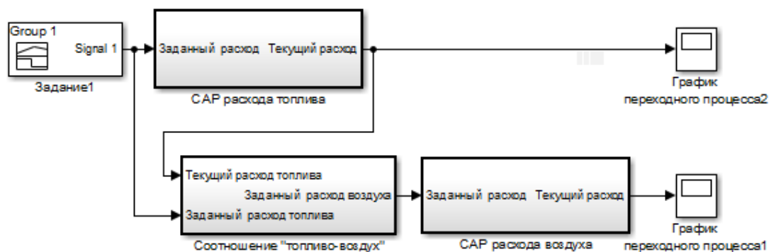
Рисунок 2 – Схема моделирования замкнутой САУ соотношением «топливо-воздух» в рабочем пространстве печи
