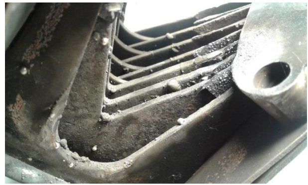
Рисунок 2 – Дугогасительная камера автоматического выключателя А3792 со следами электродугового воздействия при коммутации высоких токов: а - керамическая накладка в нижней части камеры со следами теплового воздействия электрической дуги; б - медные наплавления на дугогасительной
