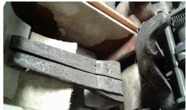
Рисунок 3 – Состояния поверхности силовых контактов автоматического выключателя А3792: а – подвергшихся электродуговому воздействию в процессе отключения высоких токов; б – нормальное состояние контактов
