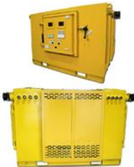
Рисунок 2 – Общий вид преобразователя частоты в рудничном
