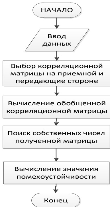
Рисунок 3 – Блок схема алгоритма вычисления помехоустойчивости для системы MIMO в условиях однородного и постоянного во времени канала.
