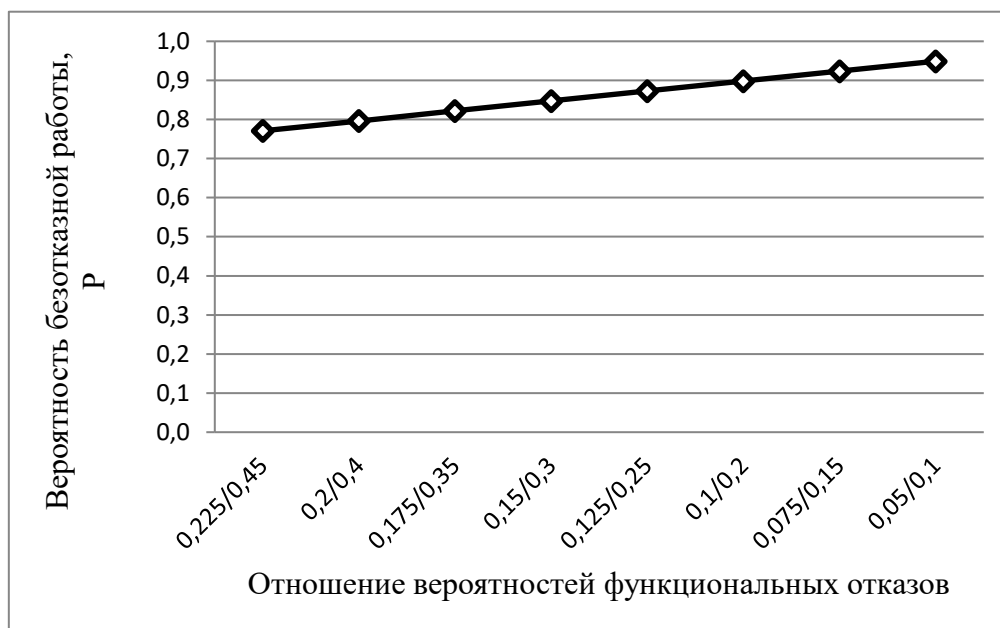
Рисунок 3 - Зависимость вероятности безотказной работы сети от отношения вероятностей функциональных отказов с двухуровневой защитой.
