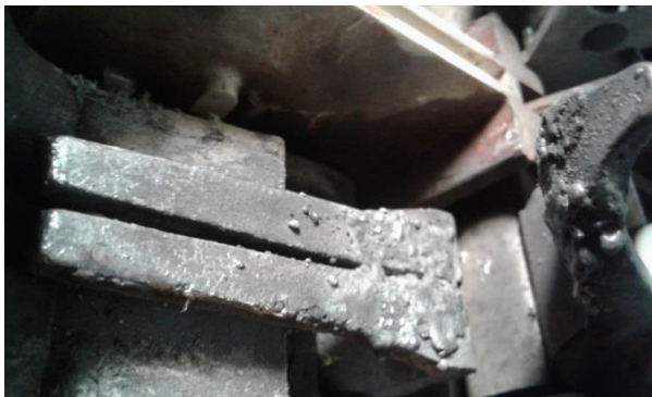
Рисунок 3 – Состояния поверхности силовых контактов автоматического выключателя А3792: а – подвергшихся электродуговому воздействию в процессе отключения высоких токов; б – нормальное состояние контактов
