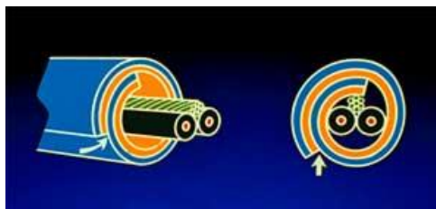
Рисунок 3 – Экранирование на основе сэндвича
