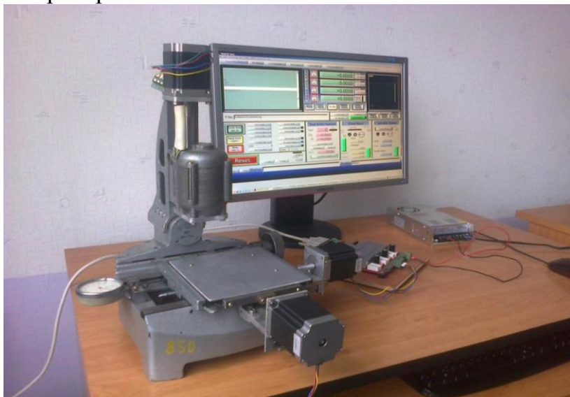
Рисунок 3 – Общий вид настольного вертикального сверлильно-фрезерного станка с системой управления Mach3
