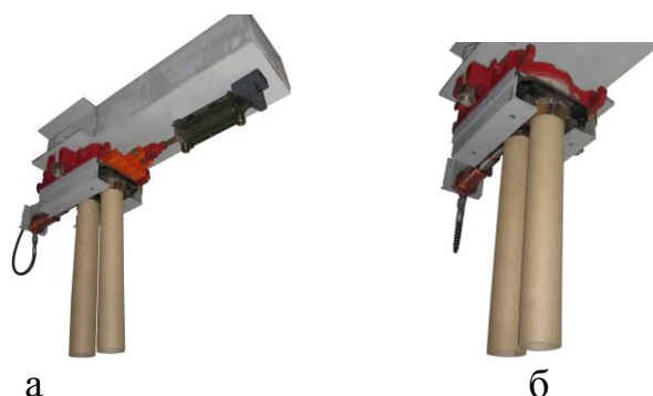
Рисунок 3 – Системы быстрой смены погружных стаканов для промежуточных ковшей слябовых МНЛЗ, оборудованных шиберными затворами (а) и стопорными устройствами (б)
